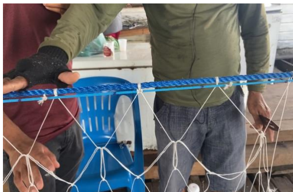
Figura 1 – Fabricação da rede de malha com destaque à malha (nesse caso 9 cm)
